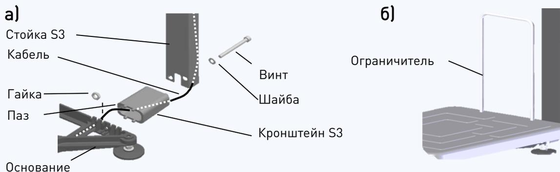
Рис. 6.2. - Крепление прямоугольной стойки к модулю ТВ-S\_
